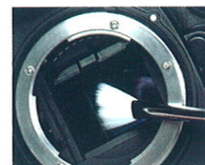
ブローでゴミを除去
